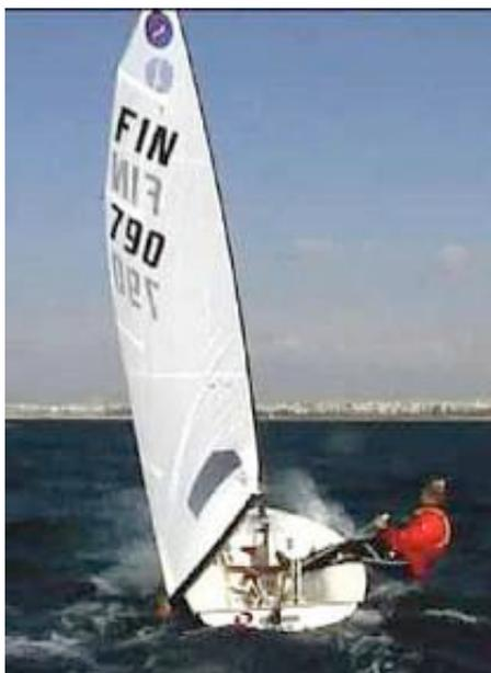
Quand la brise se renforce de nouveaux plis apparaissent... Ceci est tout à fait normal même si ce n'est pas joli. Lorsque le bateau s'arrête dans les vagues le vent apparent adonne brutalement tendant à faire chavirer le bateau. Avec une voile et un mât adaptés, le gréement va ouvrir automatiquement et ainsi réduire le travail de correction du barreur.
