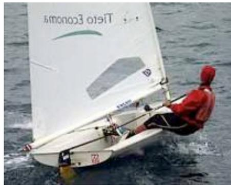
Dans 5-6 m/s, la bôme vient au niveau du caisson, prêt du coin du caisson. Pour avoir plus de puissance dans la voile, gardez la bordure arrière relâchée et laissez le cunningham détendue jusqu'à environ 6 m/s (12 noeuds) de vent.
