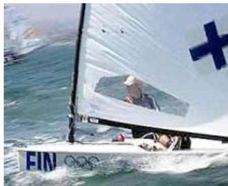
Comme le vent augmente, vous voulez commencer à tendre tout pour aplatir la voile et lâcher un peu de puissance. Inclinez la dérive en arrière pour balance la coque et placez la bôme dans le coin du caisson.
