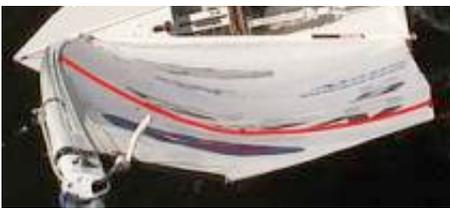
**Profil de la voile** avec 3-4 m/s, vue par l'oeil de la caméra de tête. On est assis sur le caisson, jambes serrées, collées à la barre d'écoute. **La barre d'écoute** est réglée pour avoir la bôme calée entre le milieu du caisson et le coin du tableau.
